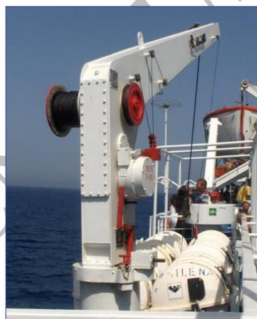
**Fig. 302** – gru per ammainare le zattere
