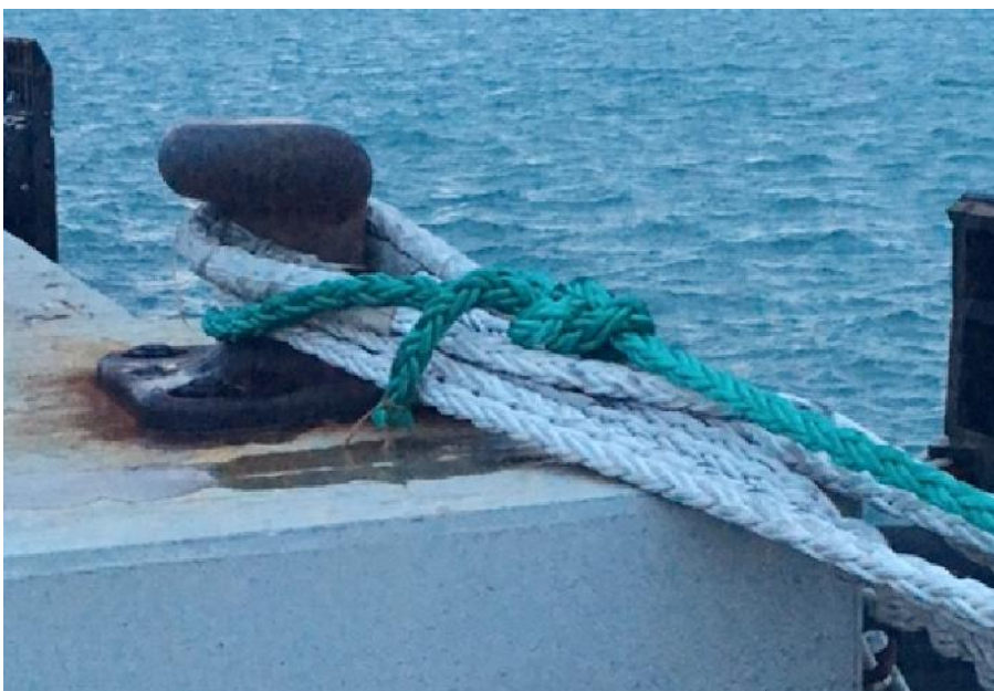
Foto 3 – Nuovi ormeggi a poppa sulla bitta della banchina
